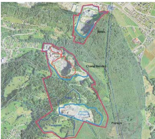
L'extension «Freneys III» en bleu foncé sur le plan devrait permettre l'extraction de 17 millions de m<sup>3</sup> de roche. | Famsa
